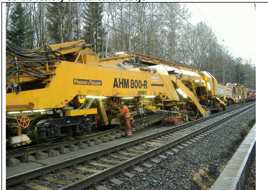
Obr.č.5 Vzorový obr. sanačního stroje
